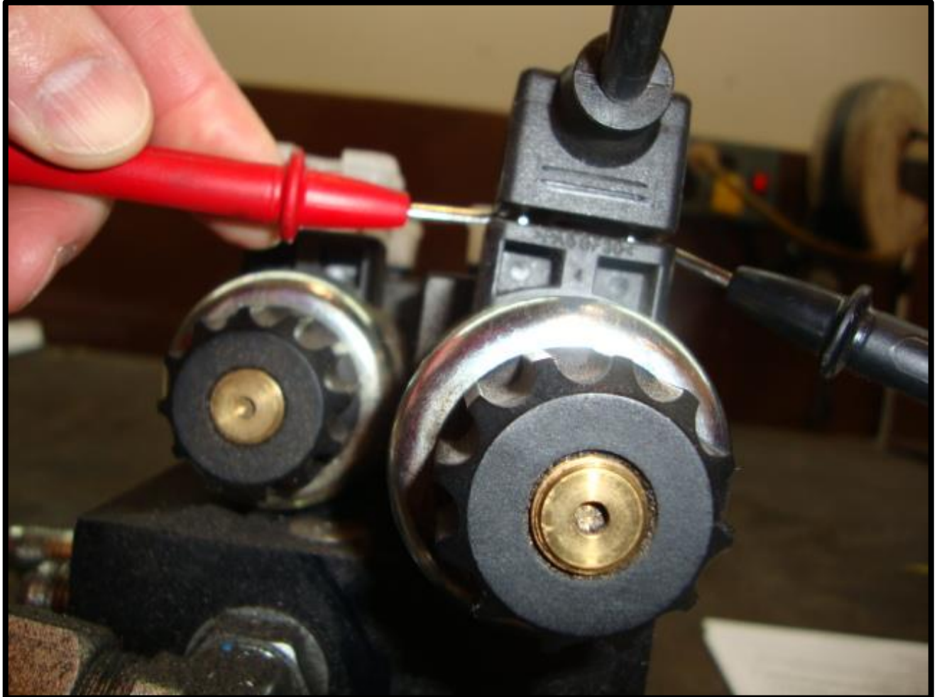
Fig. 8-4 Checking Din Plug Voltage
